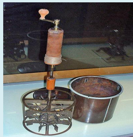
Aparatul pentru determinarea echivalentului mecanic al caloriei
