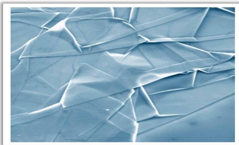
Figura nr. 1. Foițe de grafen pe o placă de siliciu [1]
